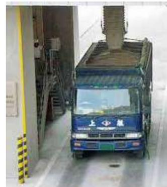
ダストが飛散せず、フード無しで作業性の良いローダーを採用しています。1系列200トン/時の積み込み能力があります。
